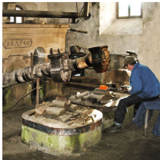
Oben: In der Schulmühle Veilbronn in Heiligenstadt bei Bamberg wird nicht mehr gemahlen, sondern Schnaps gebrannt. Unten: In der Hammerschmiede im niederbayerischen Breitenberg wurden von 1768 an Werkzeuge hergestellt. Heute dient der schwere Doppelhammer nur noch zu Vorführungszwecken.
